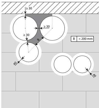
3. Les clapets peuvent être installés à distance minimale d'une paroi ou d'un autre clapet.
