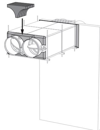
14. Colmatez l'espace du côté des distances minimales à l'aide de panneaux rigides de laine de roche ( $150 \text{ kg/m}^3$ ) sur une profondeur de 150 mm.
