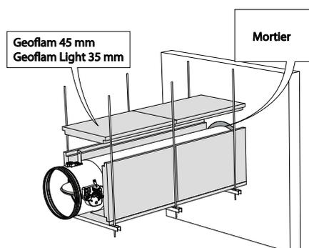
5. La réservation autour de la gaine dans la paroi est remplie par du mortier ordinaire. La gaine traversante est recouverte de plaques de staff de référence GEOFLAM F d'épaisseur 45 mm ou GEOFLAM Light d'épaisseur 35 mm « G ». Les plaques sont fixées entre elles autour de la gaine par colle et polochonnage « E ». Le corps du clapet est également ainsi protégé sur une longueur de 171 mm.
