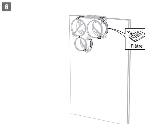
6. Colmatez le reste de la réservation à l'aide de plâtre standard sur l'épaisseur totale de la paroi.
