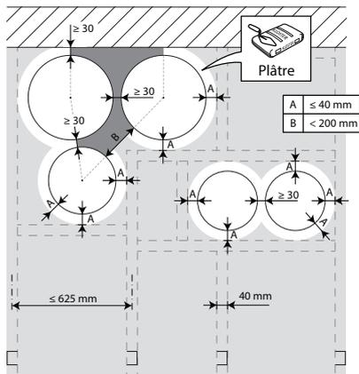
3. Les clapets peuvent être installés à distance minimale ( $\geq 30$  mm) d'une paroi ou d'un autre clapet.
