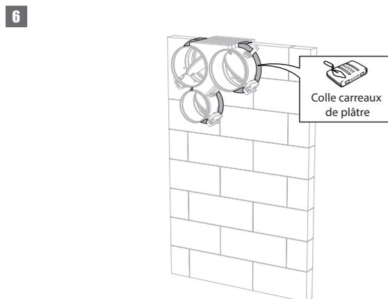
6. Colmatez le reste de la réservation à l'aide de colle à carreaux de plâtre sur l'épaisseur totale de la paroi.
