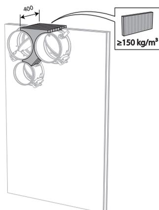
7. Installez et fixez les clapets dans la réservation. Colmatez la réservation du côté des distances minimales à l'aide de panneaux rigides de laine de roche ( $\geq 150 \text{ kg/m}^3$ ) sur une profondeur de 400 mm (150 mm du côté mécanique de la paroi).
