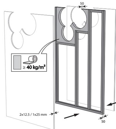
4. Assemblez la paroi légère en prévoyant les chevêtres horizontaux et verticaux nécessaires pour la réservation. Dans la réservation autour des clapets, le vide entre les plaques de plâtre cartonné est partiellement rempli (jusqu'à  $Dn + 80$  mm) de laine de roche d'une densité minimale de  $40 \text{ kg/m}^3$ .
