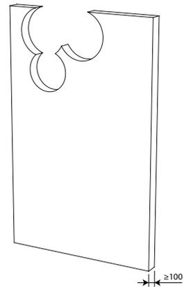
4. Prévoyez dans la dalle les réservations nécessaires ( $\leq Dn + 80$  mm).
