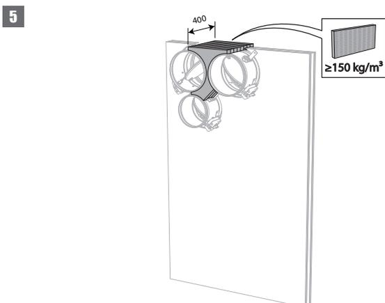
5. Installez et fixez les clapets dans la réservation.
