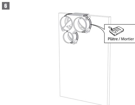
6. Colmatez le reste de la réservation à l'aide de mortier ou de plâtre standard.
