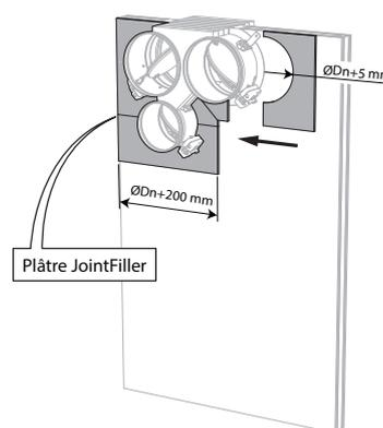
8. Finissez la surface des 2 côtés avec des talons de plâtre. Rejointoyez les espaces entre les talons et entre talons et plaques à l'aide de jointfiller.
