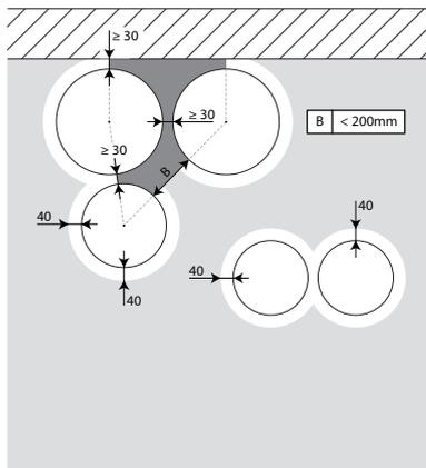
3. Les clapets peuvent être installés à distance minimale ( $\geq 30$  mm) d'une paroi ou d'un autre clapet.
