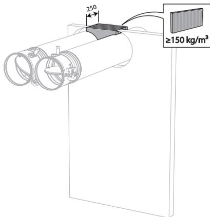
11. Colmatez la réservation du côté des distances minimales à l'aide de panneaux rigides de laine de roche ( $150 \text{ kg/m}^3$ ) sur une profondeur de 250 mm (épaisseur de la paroi + additionnel à l'arrière de la paroi).
