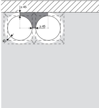
9. Les clapets peuvent être installés à distance minimale d'une paroi ou d'un autre clapet.
