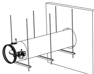
4. Le clapet est monté déporté sur une gaine traversante en tôle d'acier galvanisé. Un supportage est mis en oeuvre au pas de 1000 mm.
