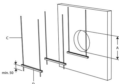
3. L'ouverture de dimensions maximales « A » est réalisée au travers de la paroi.
